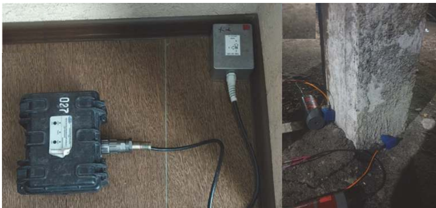
Рис. 38. Расположение трехканального датчика на полу Дворца культуры (а); расположение двух одноканальных датчиков на свае (б)
